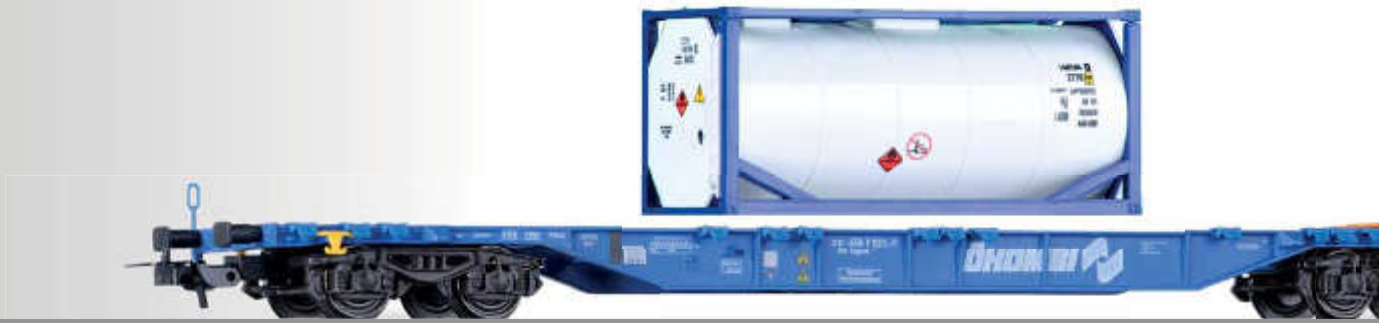
Doppeltragwagen Sdggmrss 744 „Ökombi“ der ÖBB mit einem 40' Container und einem 20' Tank-Container Container car Sdggmrss „Ökombi“ of the ÖBB with load
